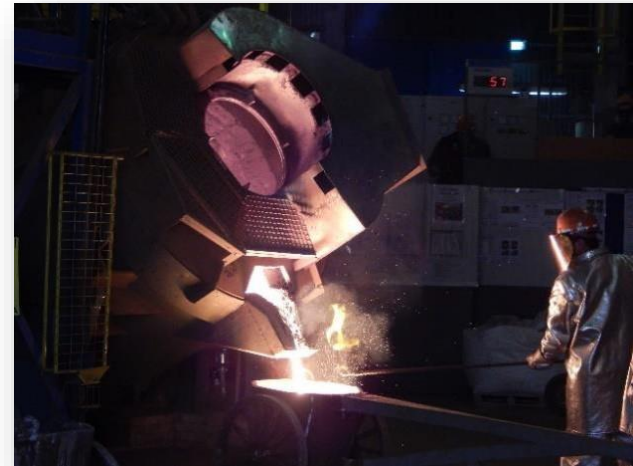
Essais de production d'acier avec la Bauxaline® comme source de fer
